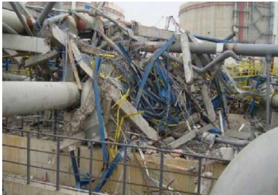
پوکیدن یک سایت در زمان تست نیوماتیک به دلیل شکست ترد
