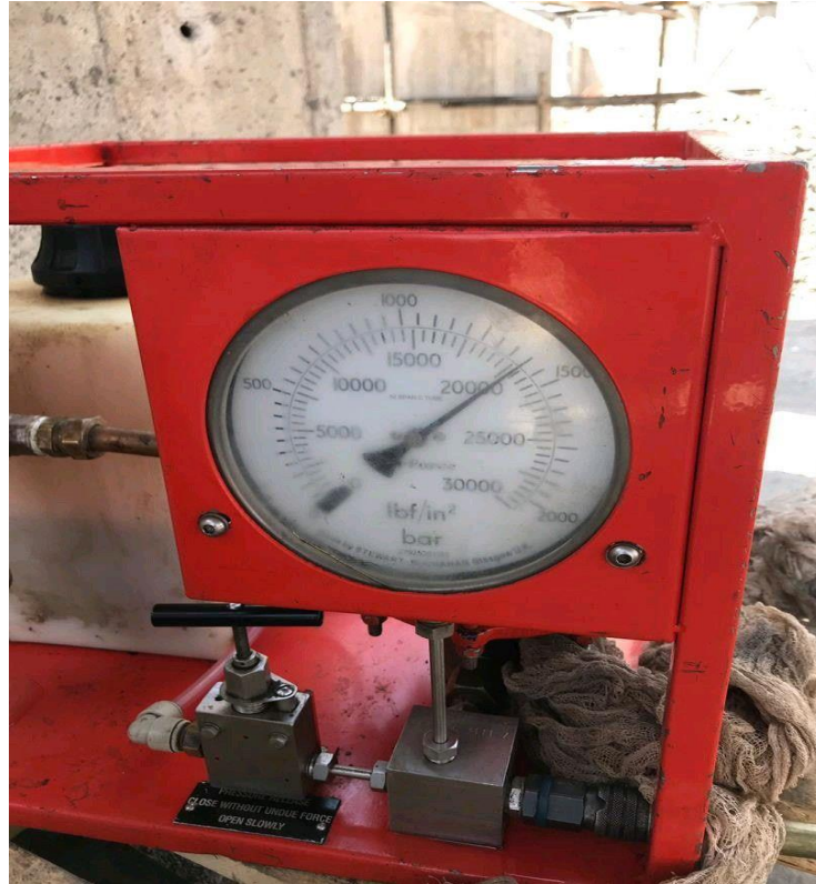
فشار تست یک ظرف تحت فشار پتروشیمی با فشار ۱۴۰۰ بار معادل 20000 Psi
