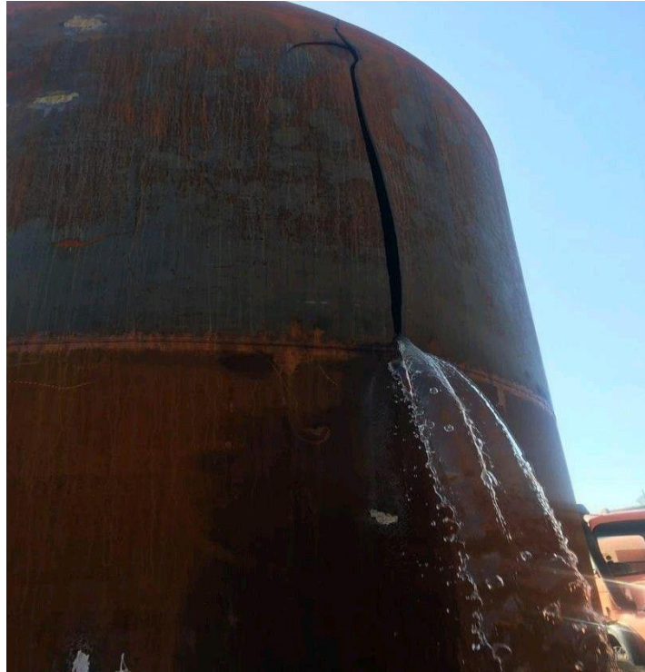
شکست ترد در زمان تست هیدرواستاتیک یک مخزن ذخیره
